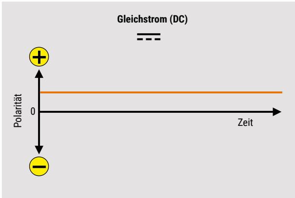
Abb. 10: Gleichstrom ändert seine Fließrichtung nicht und bleibt konstant.
