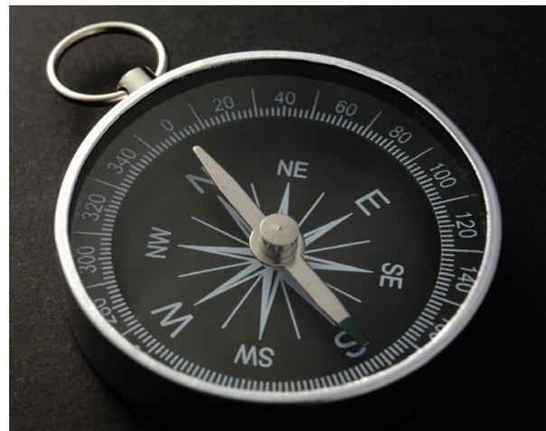
Abb. 3: Orientierungshilfe Magnetkompass: Ein horizontal beweglicher Magnet richtet sich unter dem Einfluss des Erdmagnetfeldes auf den Nordpol aus.
