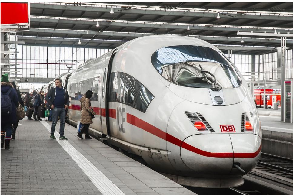
Abb. 14: In Deutschland wird im Netz der Deutschen Bahn ein einphasiger Wechselstrom mit einer Frequenz von 16,7 Hz verwendet.
